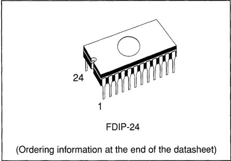
**Figure 1 : Pin Connection**
