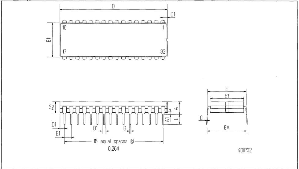
Figure 9 : 32 PIN PLASTIC DUAL IN LINE
