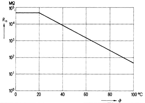
Insulation resistance  $R_{is}$ <sup>1)</sup>
