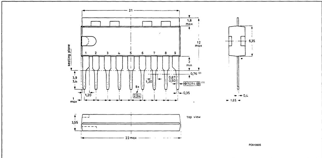
**9-PIN PLASTIC POWER SIP-BENT-TO-DIP (SOT-157B)**
