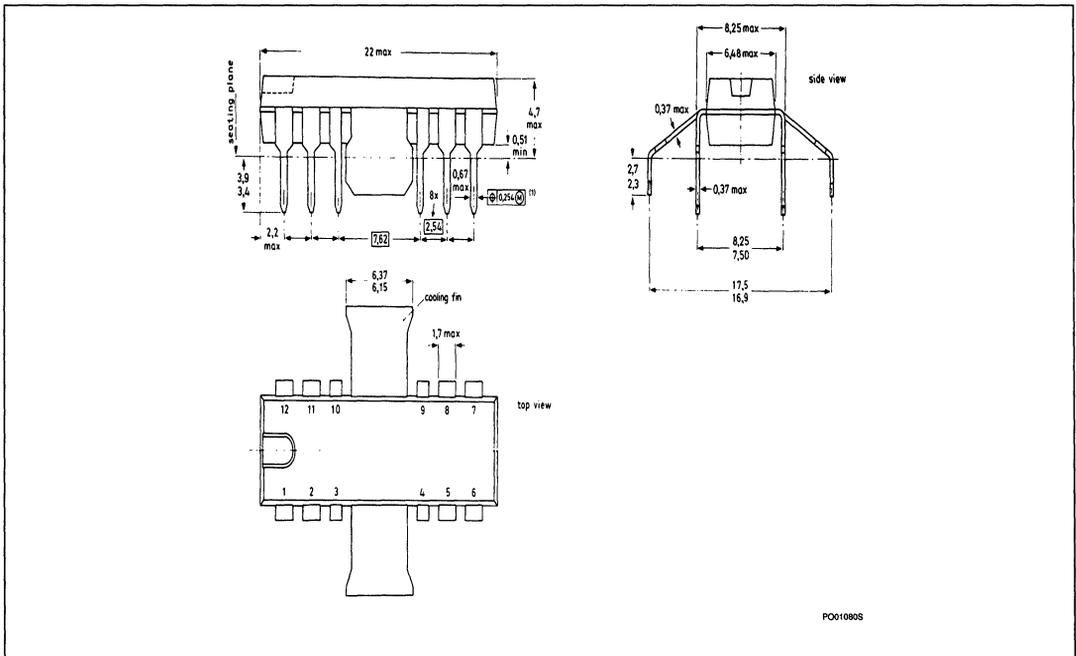
**13-PIN PLASTIC POWER SIP-BENT-TO-DIP (SOT-141B)**
