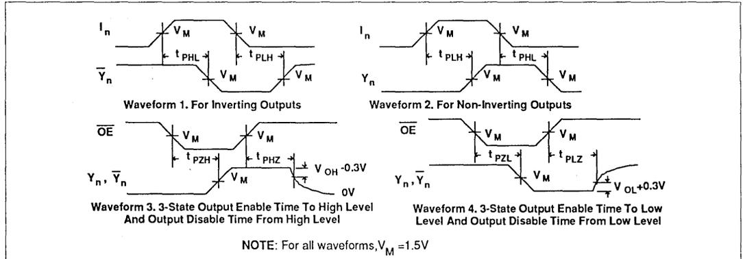
TEST CIRCUIT AND WAVEFORMS
