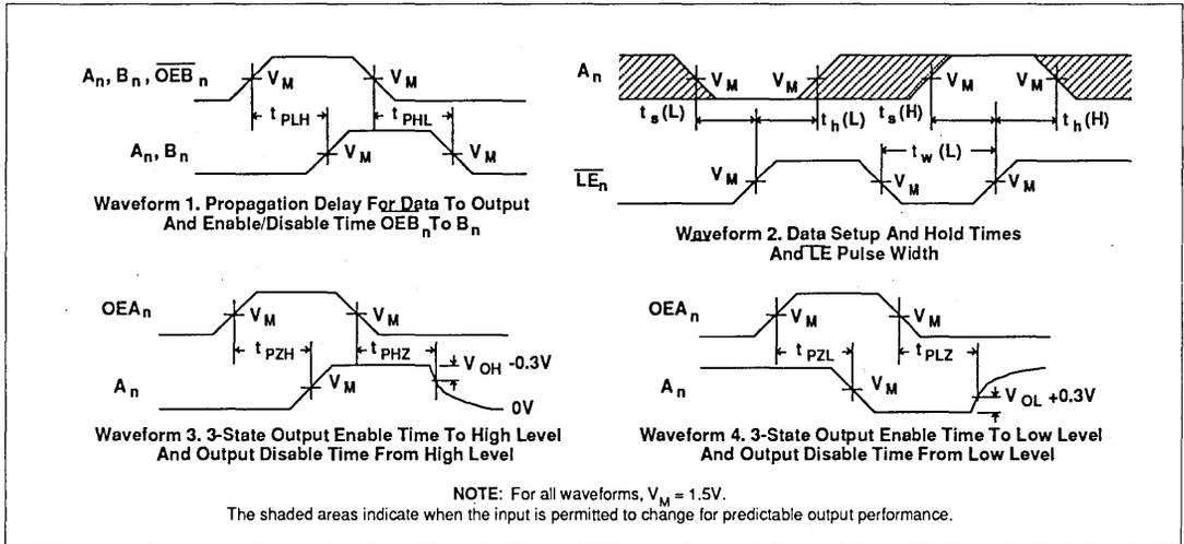
TEST CIRCUIT AND WAVEFORMS
