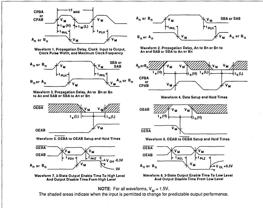
TEST CIRCUIT AND WAVEFORMS
