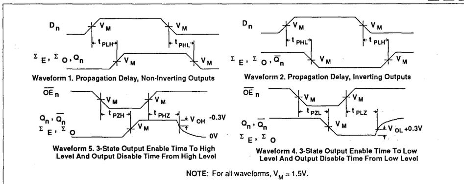
TEST CIRCUIT AND WAVEFORMS
