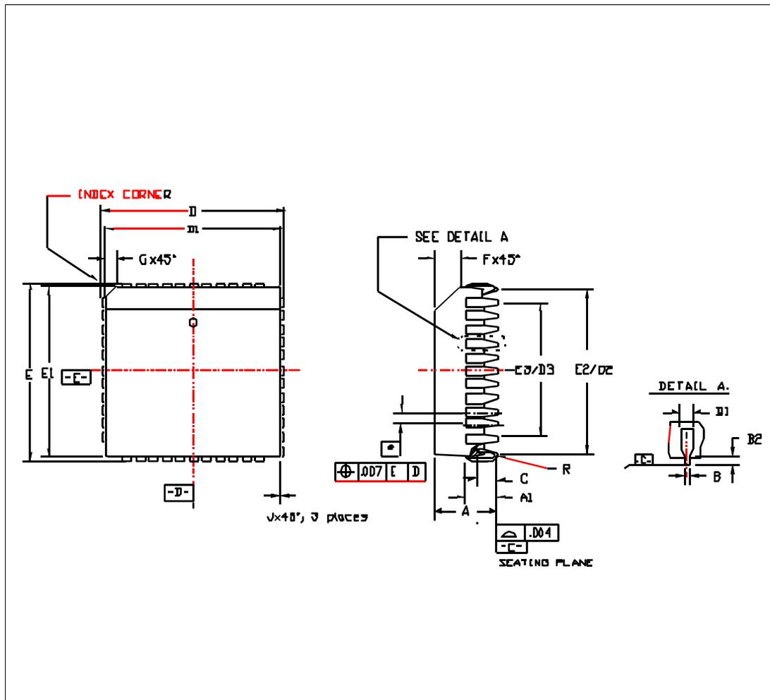
FIGURE 6-1. 44-PIN PLCC PACKAGE DIAGRAM
