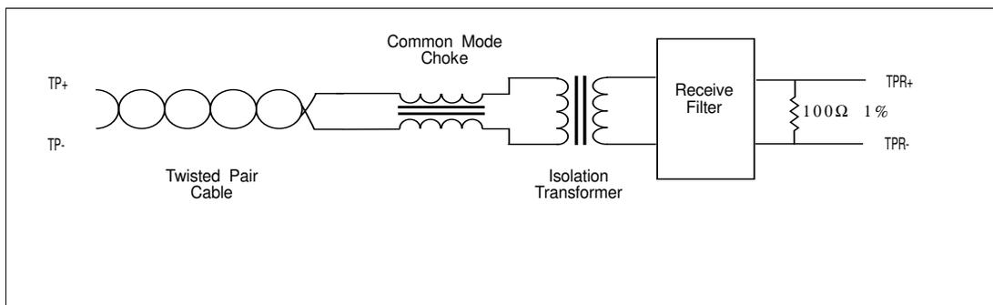
**FIGURE 2-5. TWISTED-PAIR RECEIVE PATH**
