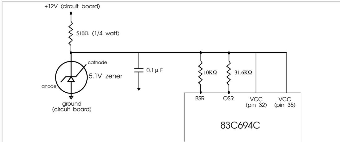
**FIGURE 2-4. ZENER DIODE VOLTAGE REGULATION FOR 12 VOLTS**
