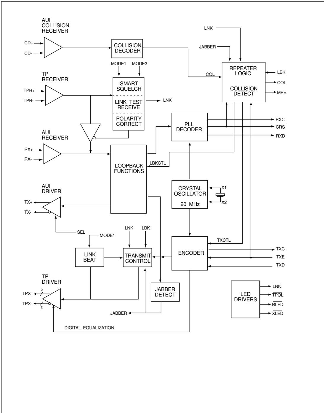
FIGURE 1-2. 83C694C BLOCK DIAGRAM
