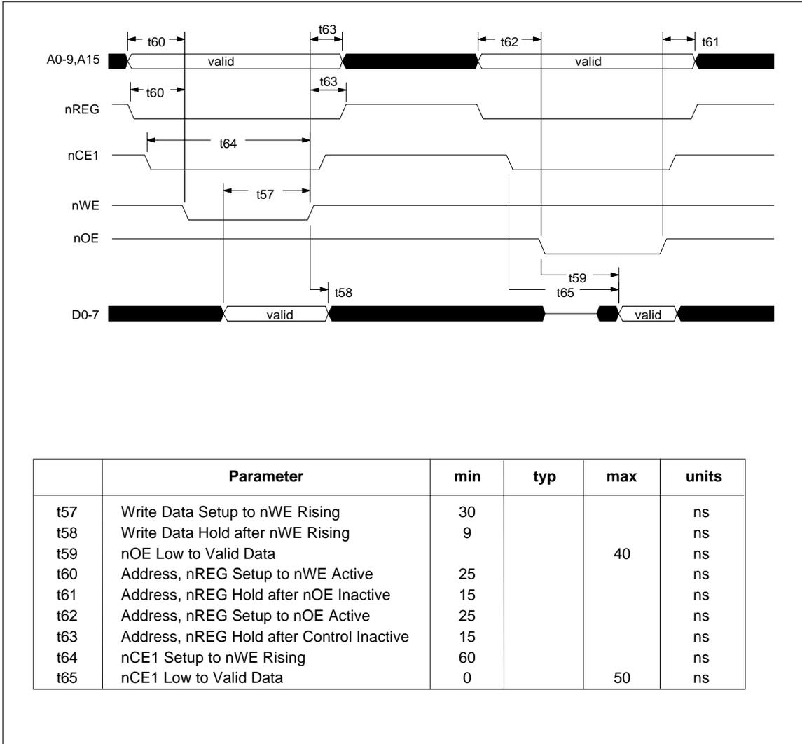
**FIGURE 20 - CARD CONFIGURATION REGISTERS - READ/WRITE-PCMCIA MODE (A15=1)**
