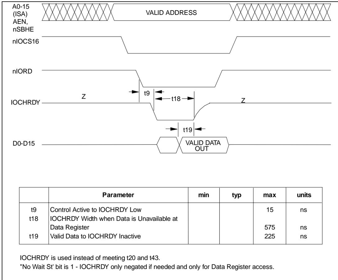
**FIGURE 26 - DATA REGISTER SPECIAL READ ACCESS**
