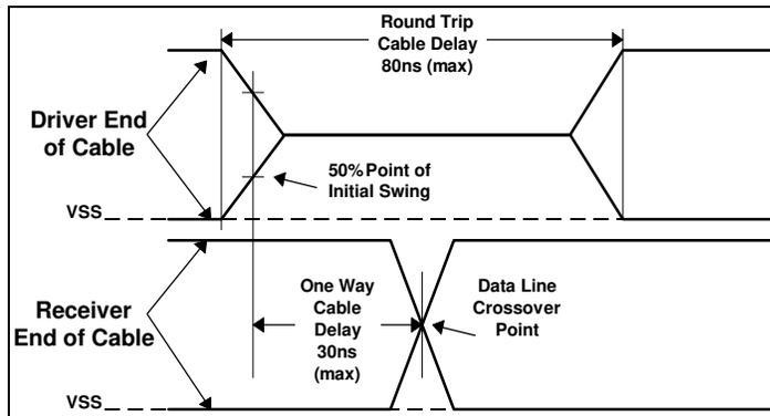
FIGURE 11 - CABLE DELAY
