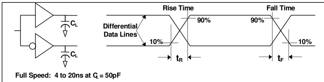
**FIGURE 7 - DATA SIGNAL RISE AND FALL TIME**
