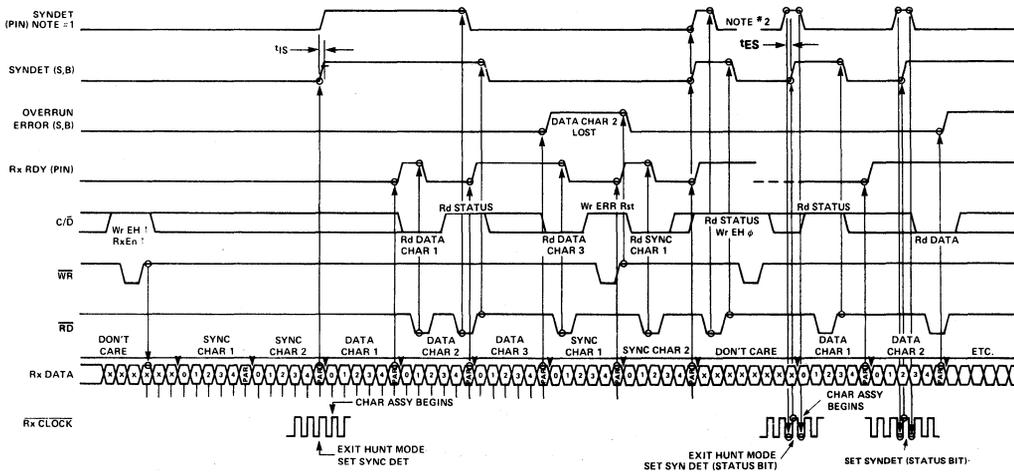
NOTE #1: INTERNAL SYNC, 2 SYNC CHARACTERS, 5 BITS, WITH PARITY
