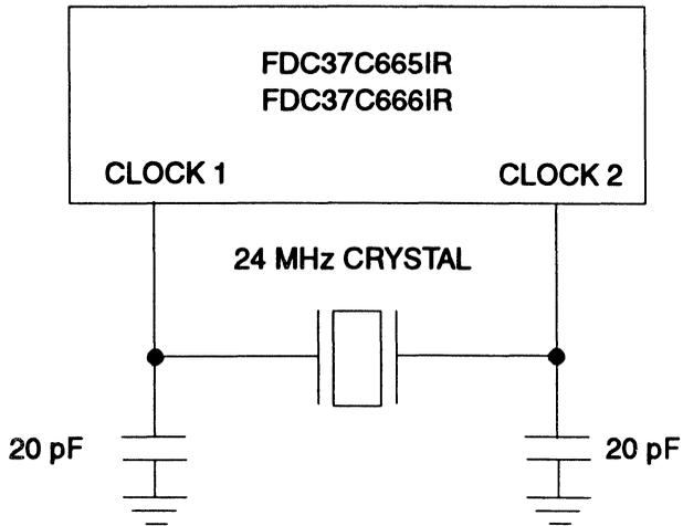
**FIGURE 2 - SUGGESTED 24 MHz OSCILLATOR CIRCUIT**
