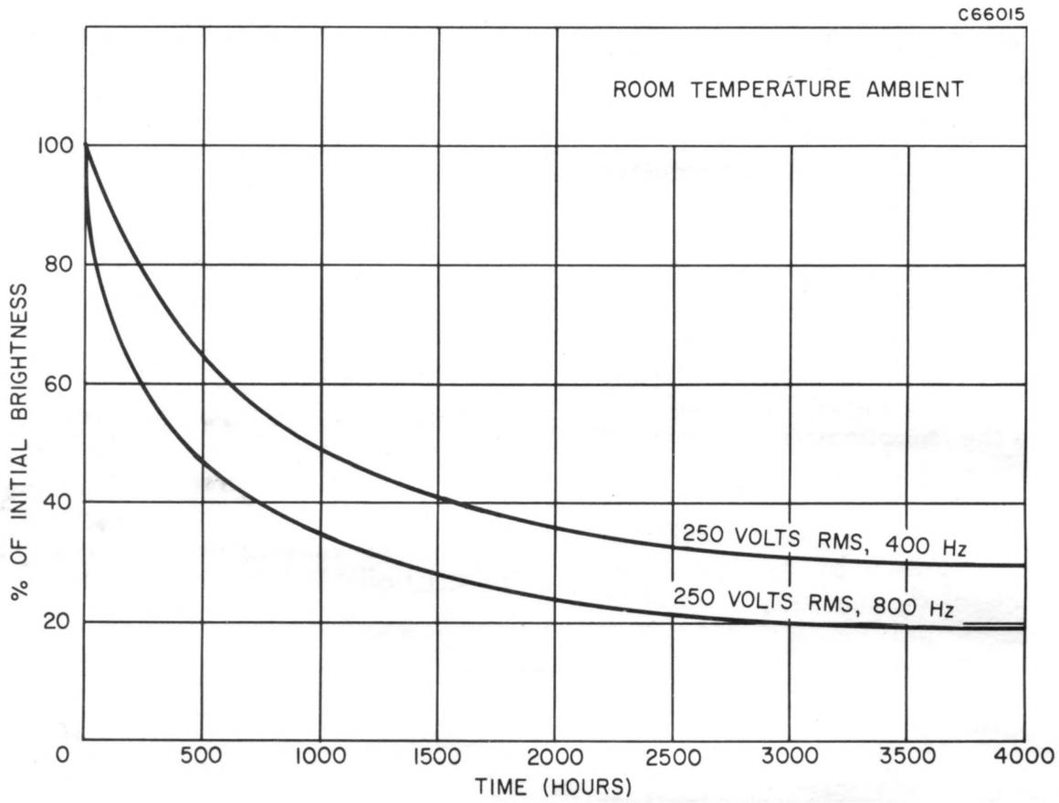
**EL READOUT BRIGHTNESS VS. VOLTAGE
