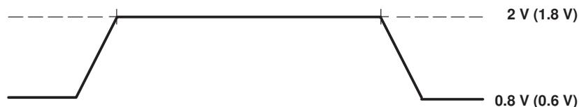
Figure 11. TTL-Level Inputs
