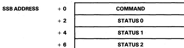
FIGURE 4-33. SYSTEM STATUS BLOCK FORMAT
