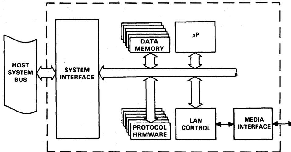
FIGURE 1-8. LAN CONTROLLER-BASED ADAPTER CARD ARCHITECTURE
