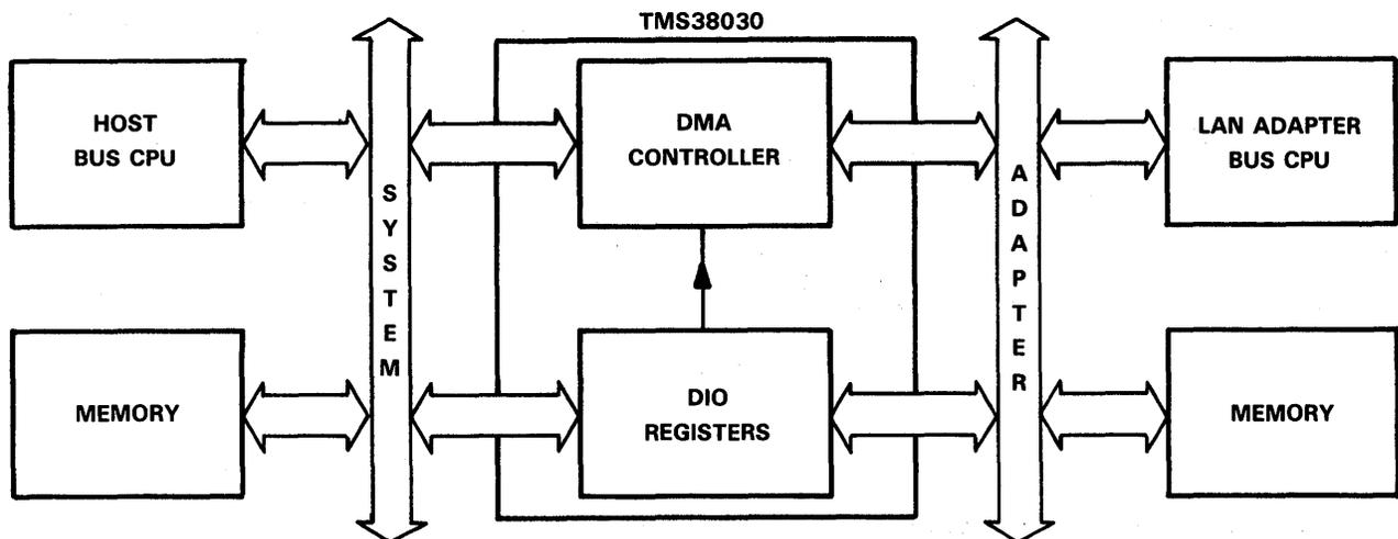
FIGURE 1. TMS38030 DMA CONTROL — CONCEPTUAL REPRESENTATION
