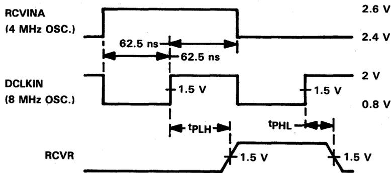
FIGURE 17. PROPAGATION DELAYS FROM DCLKIN TO RCVR
