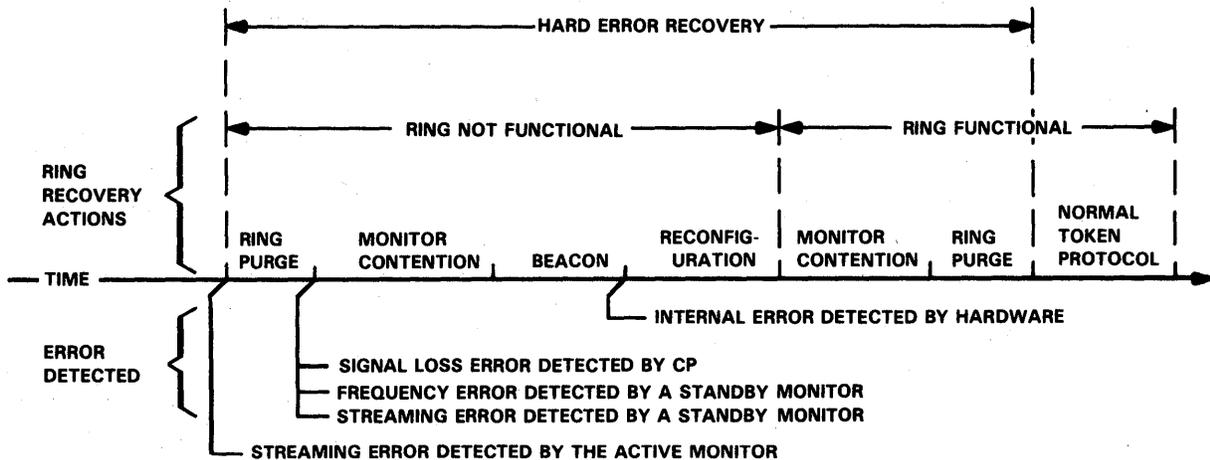
FIGURE 3-37. SOLID HARD ERROR RECOVERY TIME LINE
