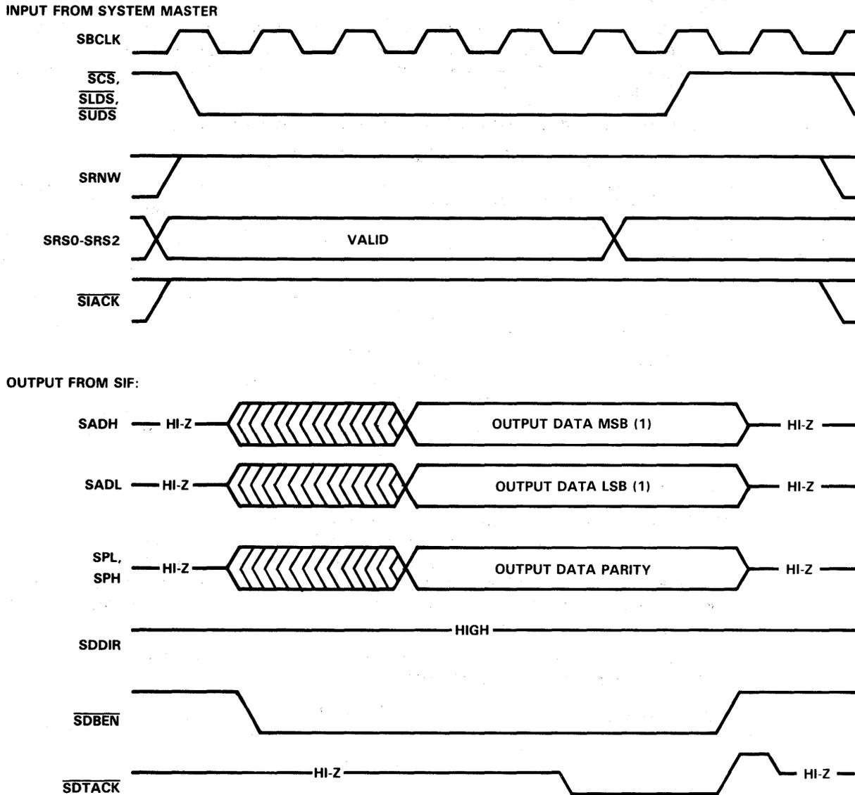
**FIGURE 4-11. 680XX MODE DIO READ CYCLE TIMING**
