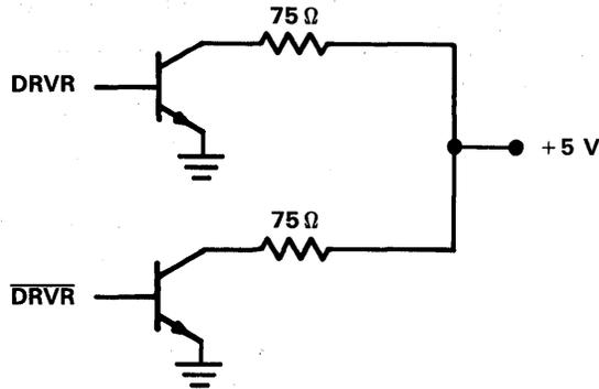
FIGURE 4-70. TMS38051 LINE DRIVER STAGE
