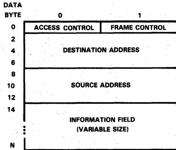
**FIGURE 4. TRANSMIT DATA FORMAT**
