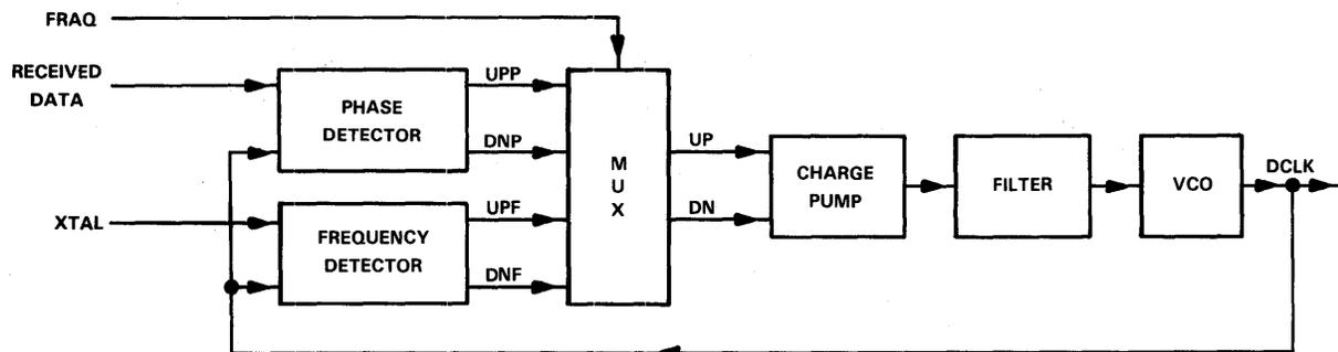
FIGURE 4-73. PHASE LOCKED LOOP BLOCK DIAGRAM
