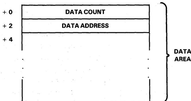
FIGURE 4-66. READ ADAPTER SYSTEM BUFFER SPACE
