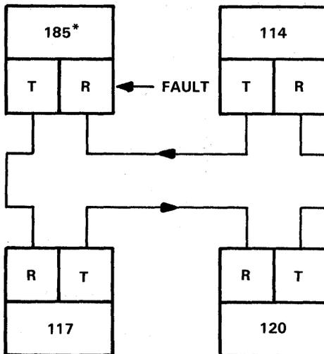
FIGURE 3-41. RECEIVER FAULT IN ADAPTER 185
