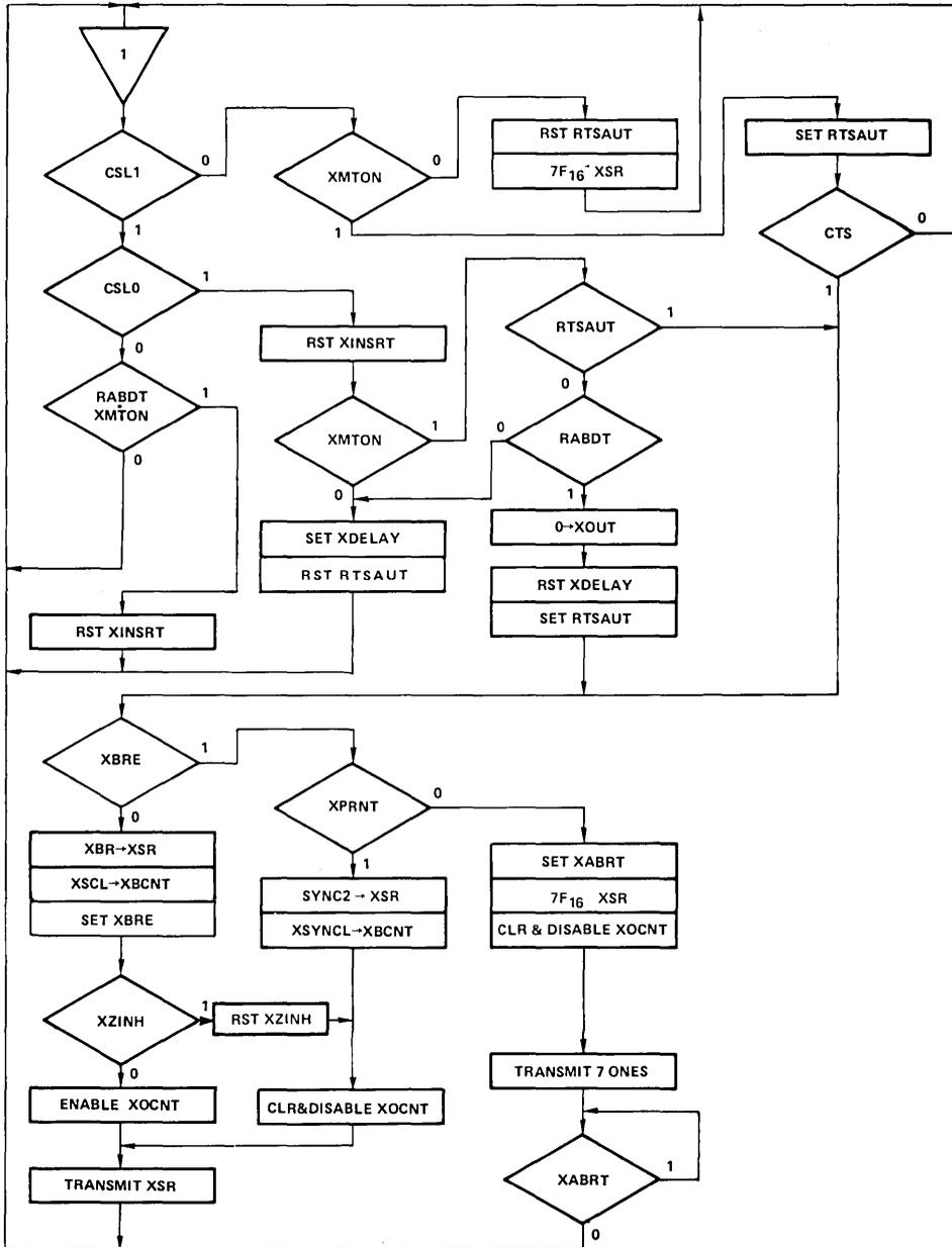
FIGURE 12. MODE 1 TRANSMITTER OPERATION
