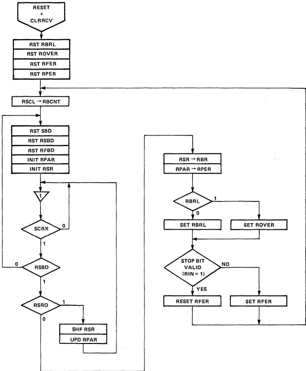
FIGURE 21. MODE 5 OR 6 RECEIVER OPERATION
