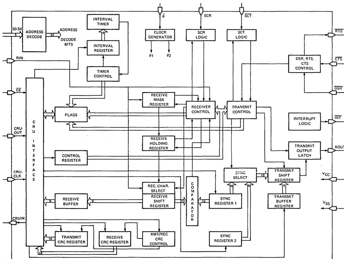
FIGURE 3. TMS 9903 SYNCHRONOUS COMMUNICATION CONTROLLER BLOCK DIAGRAM
