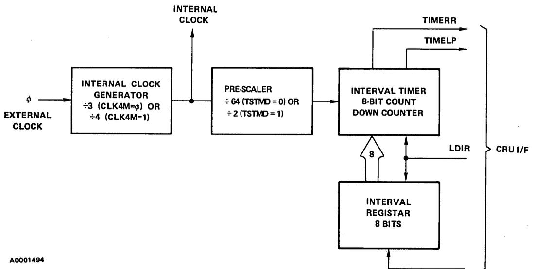
FIGURE 22. INTERVAL TIMER BLOCK DIAGRAM
