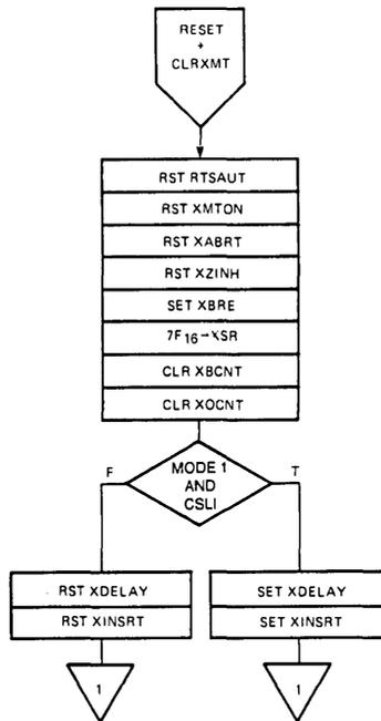
FIGURE 8. TRANSMITTER INITIALIZATION
