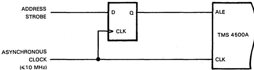
FIGURE 1 - TMS 4500A CLOCK SYNCHRONIZATION INTERFACE
