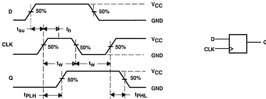
D FLIP-FLOP SHOWING POSITIVE-EDGE TRIGGERED CLOCK
