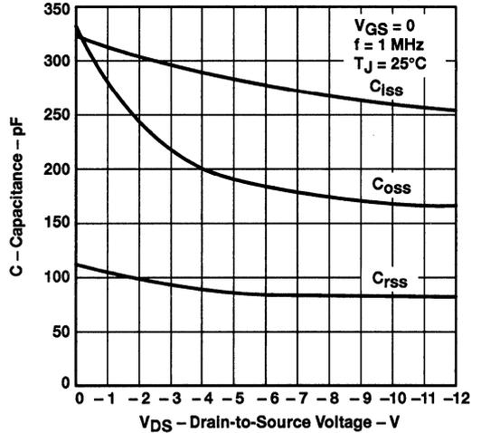
†  $C_{iss} = C_{gs} + C_{gd}$ ,  $C_{ds}(\text{shorted})$ .
