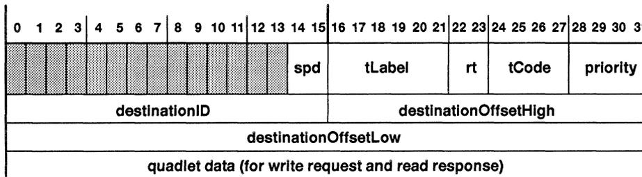
Figure 4–1. Quadlet-Transmit Format
