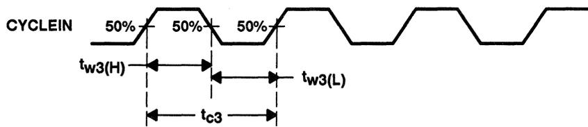
Figure 6-9. CYCLEIN Waveform
