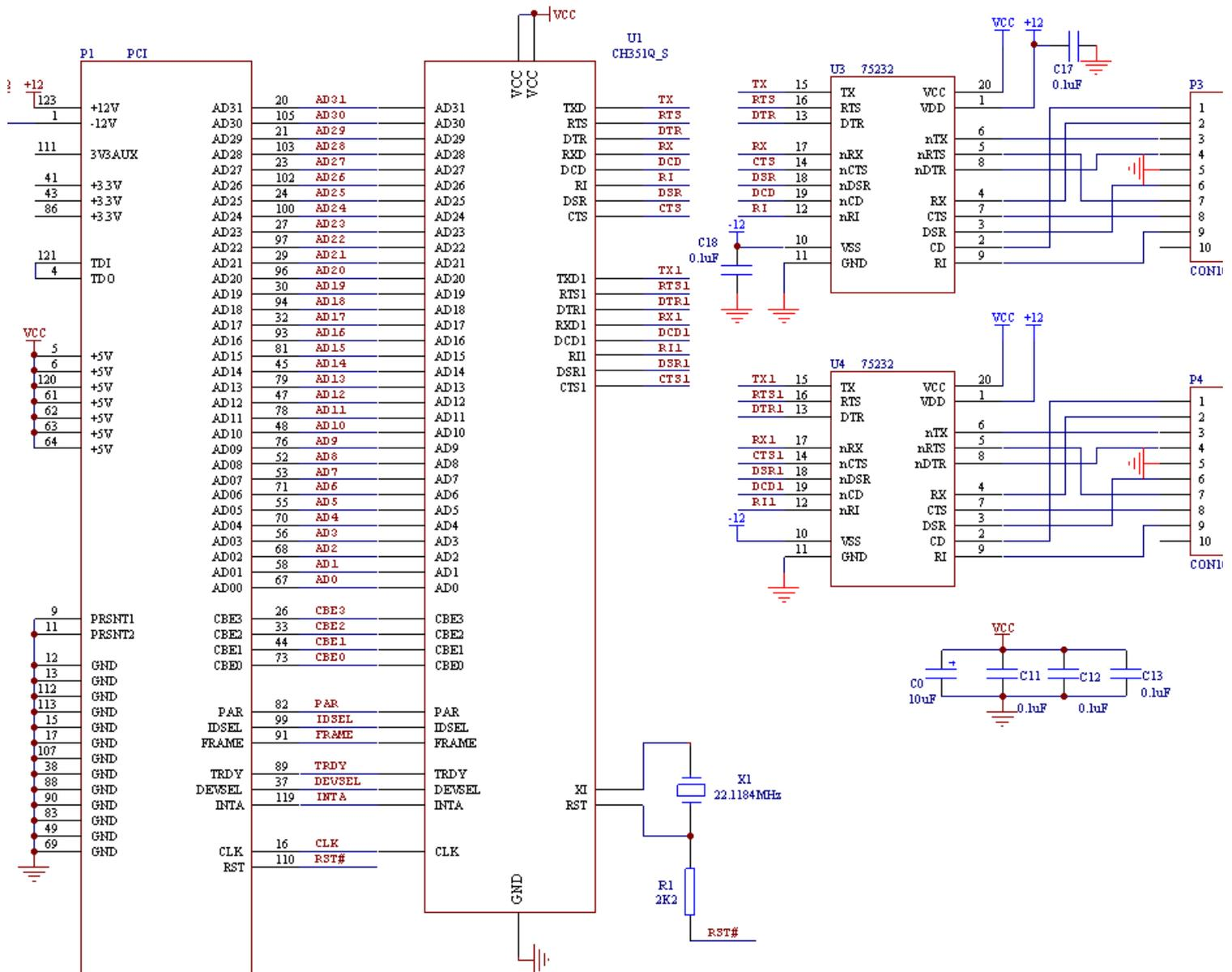
这是基于 CH351 芯片的 PCI 双通道串口的电路。U3 和 U4 是 RS232 电平转换芯片 75232，P3 和 P4 是 10 脚双排针或者 DB9 插针。晶体 X1 用于时钟振荡电路。电容 C0 和 C11~C13 用于电源退耦，C11~C13 是容量为 0.1 $\mu$ F 的独石或者高频瓷片电容，分别就近并联在 CH351 的电源引脚或者 75232 芯片的电源引脚上。
