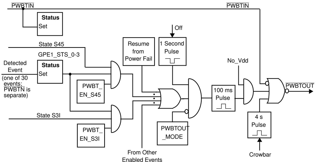
Figure 51.  $\overline{\text{PWBTOUT}}$  Control
