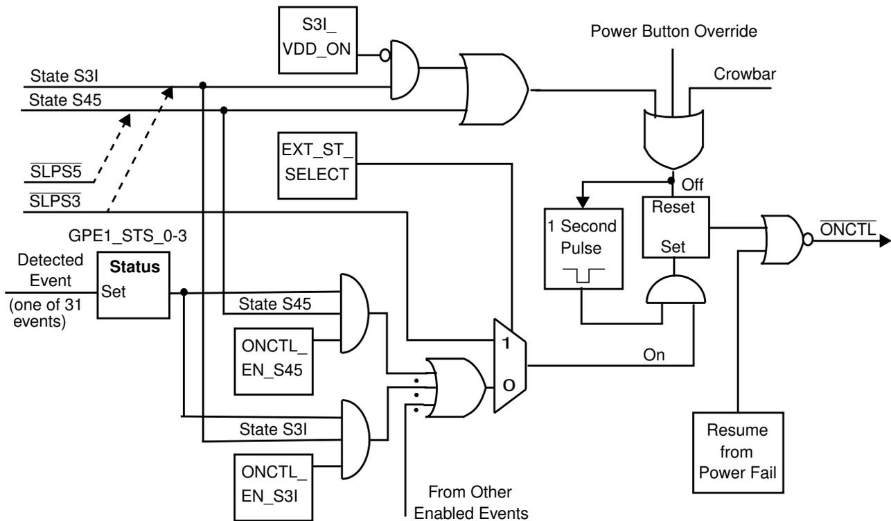
Figure 50.  $\overline{ONCTL}$  Control
