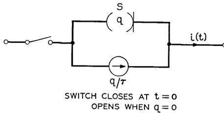
Fig. 28—Diode model.
