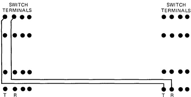
Fig. 8—Backplane wiring.
