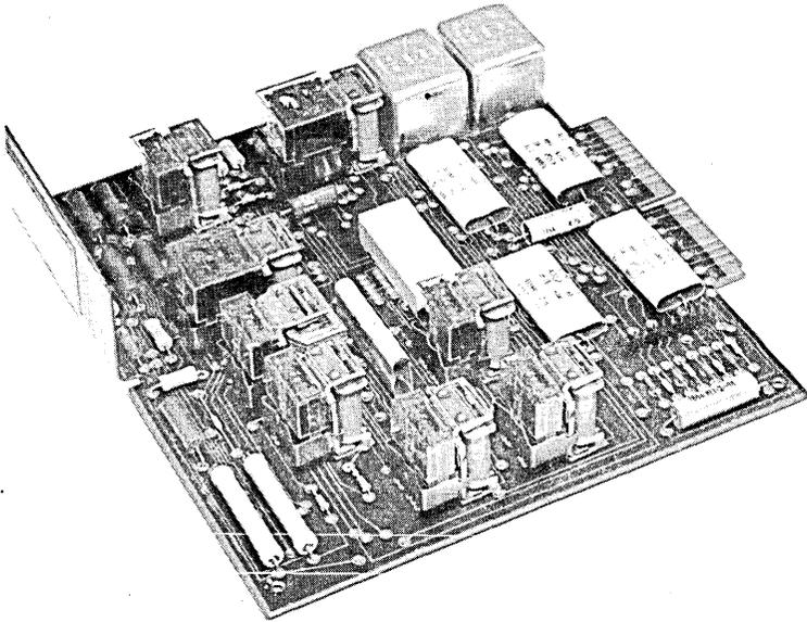
Fig. 28—CCIS plug-in trunk.
