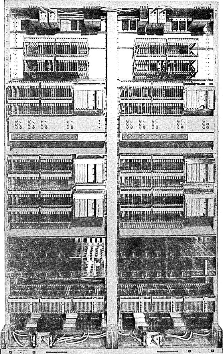
Fig. 8—4A terminal basic frame.
