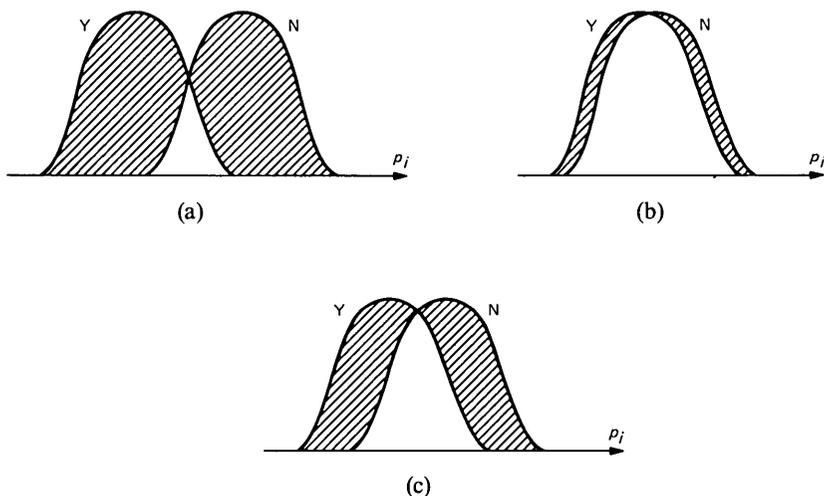
Fig. 17—Sensitivity factor  $M_i$  for parameter  $p_i$ . (a)  $M_i \approx 2$ . (b)  $M_i \approx 0$ . (c)  $0 < M_i < 2$ .
