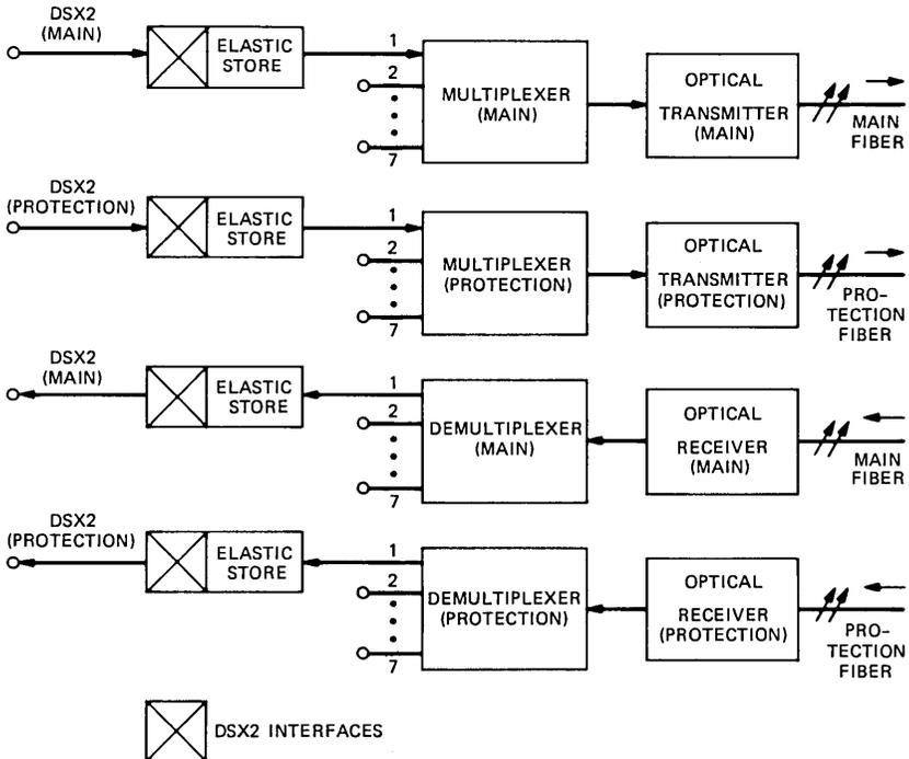
Fig. 17—Block diagram of DS2/DS3 multiplexer.
