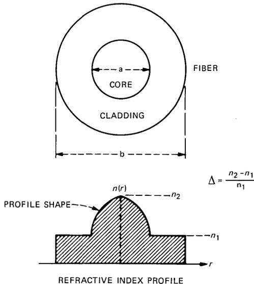
Fig. 6—Fiber parameters.
