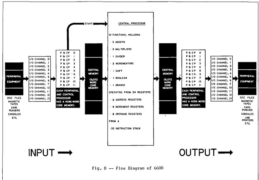
Fig. B -- Flow Diagram of 6600
