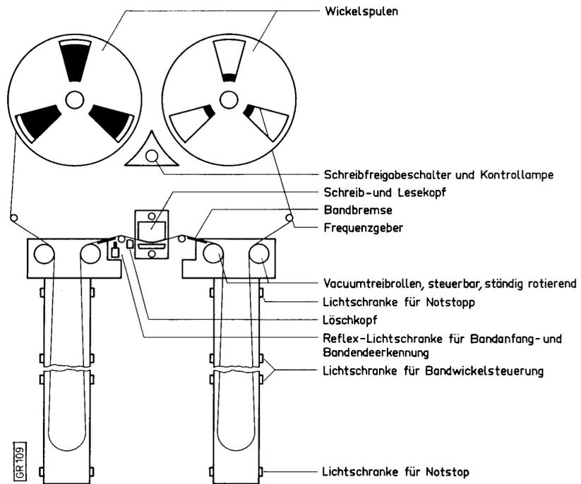
Funktion des Magnetlaufwerkes
