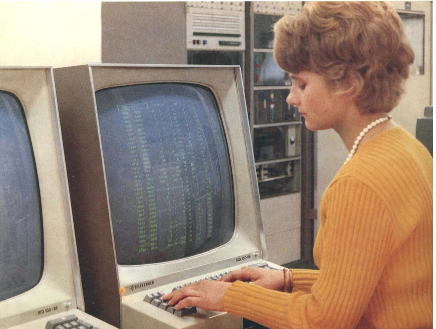
Die zunehmende Ausbreitung von Vielbenutzer-Systemen führt zu einer wachsenden Nachfrage nach Datensichtgeräten. Speziell für die Verwendung in derartigen Systemen hat AEG-TELEFUNKEN die Sichtgeräte SIG 100 (für graphische und alphanumerische Darstellungen) und SIG 50 (für alphanumerische Darstellungen) entwickelt. Das Bild zeigt zwei Geräte vom Typ SIG 100 im Prüffeld
