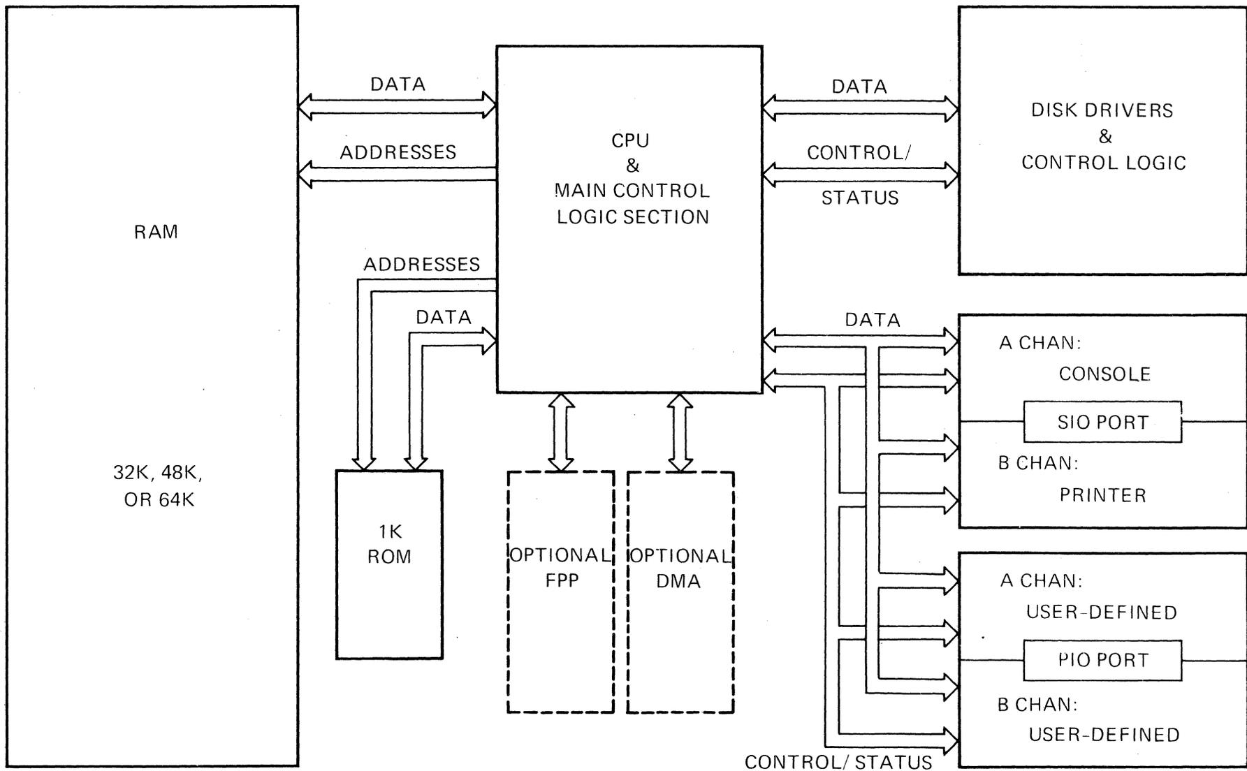
FIGURE 5 ACS8000 BLOCK DIAGRAM
