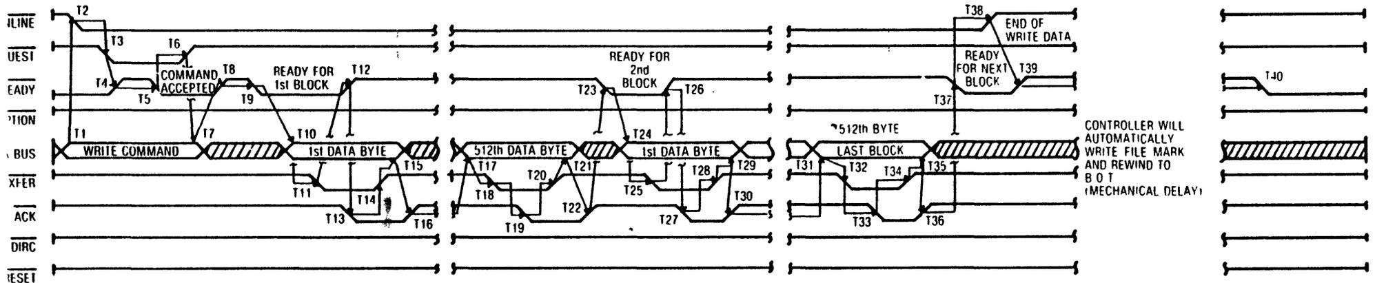
CONTROLLER WILL AUTOMATICALLY WRITE FILE MARK AND REWIND TO BOT (MECHANICAL DELAY)
