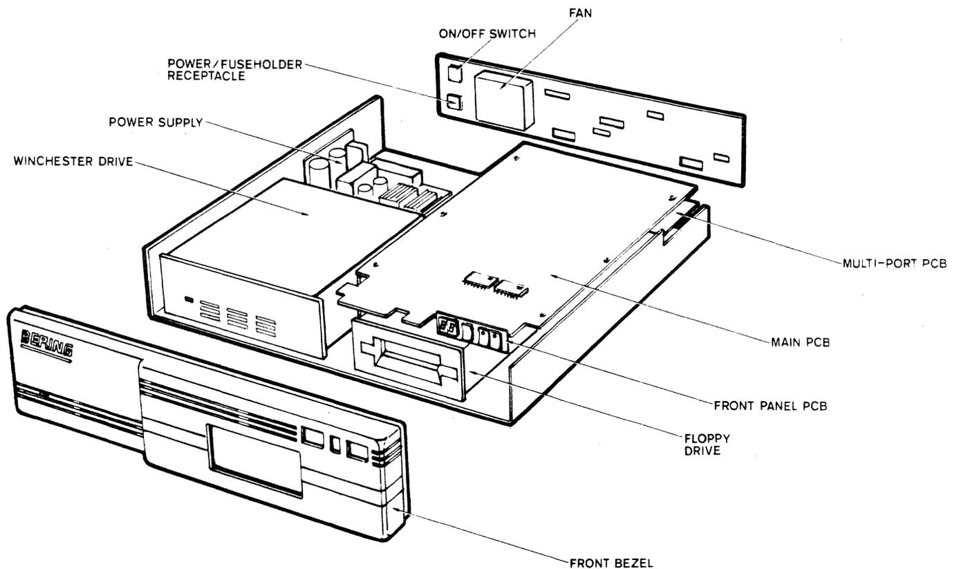
Figure 1.1 Disk Subsystem Modules
