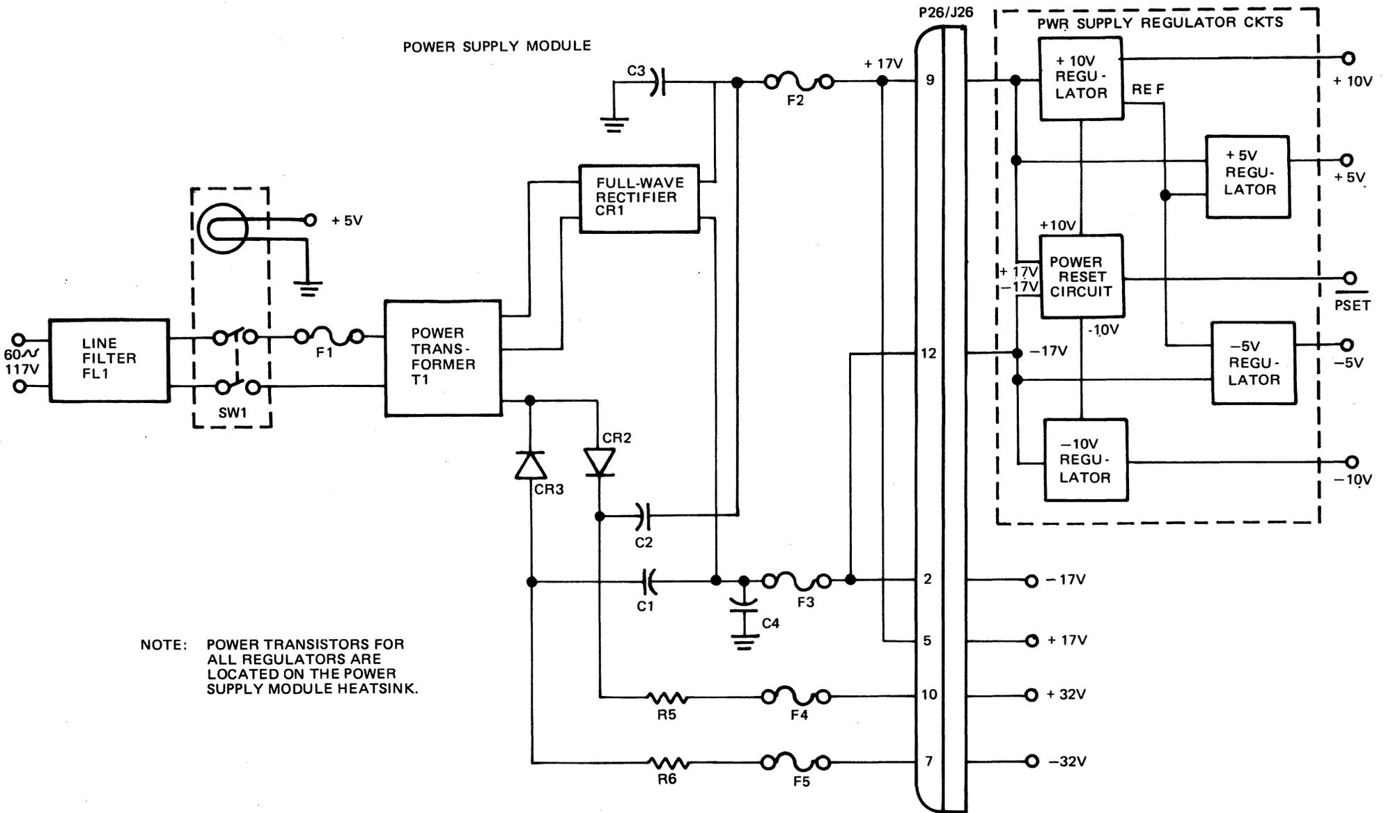
NOTE: POWER TRANSISTORS FOR ALL REGULATORS ARE LOCATED ON THE POWER SUPPLY MODULE HEATSINK.
