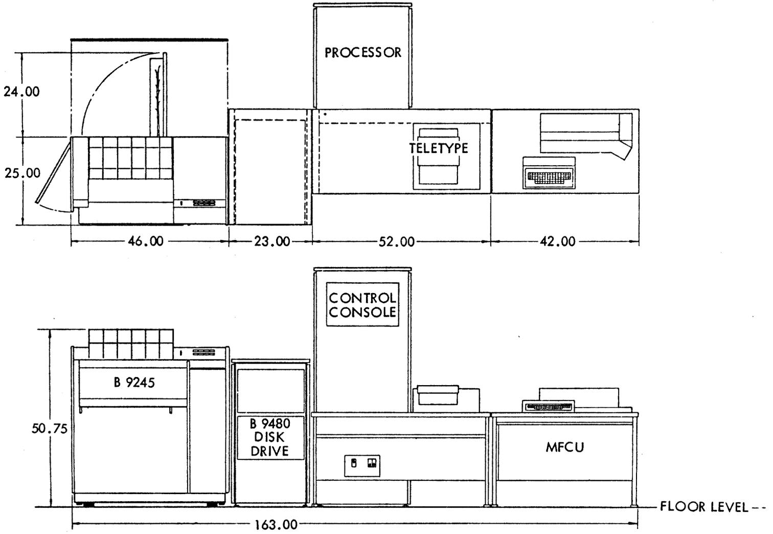
Figure IV-9. B 1712/B 1714 Straight Configuration
