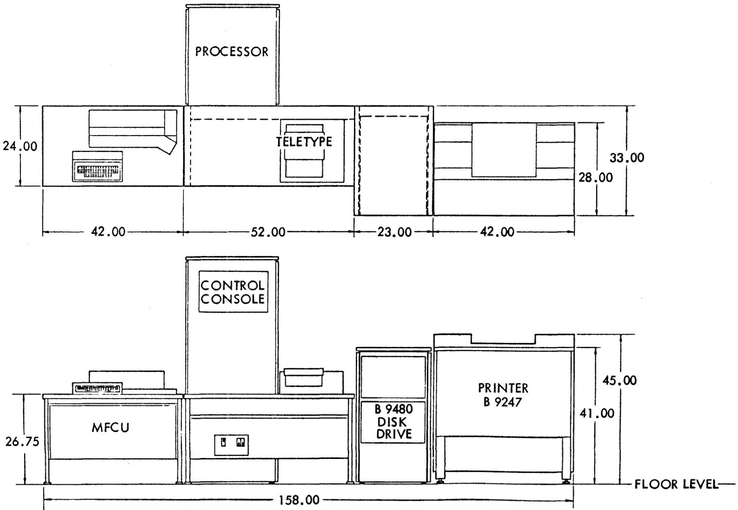
Figure IV-9. B 1712/B 1714 Straight Configuration
