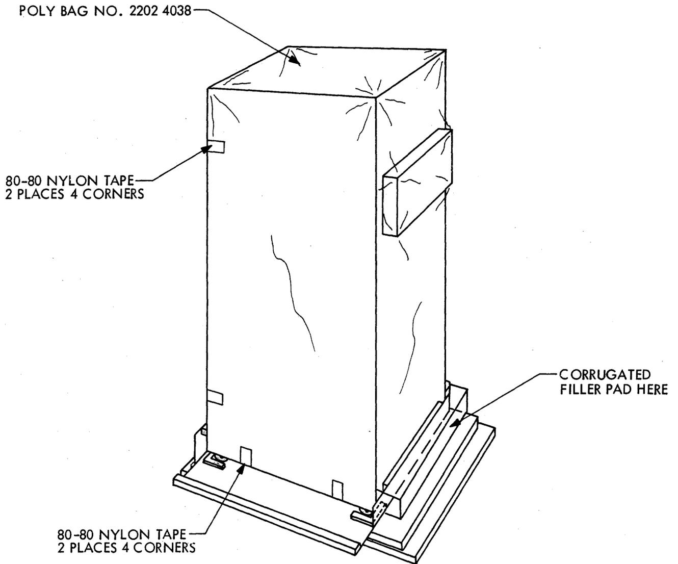
Figure IV-2. B 1712/B 1714 Inner Packing
