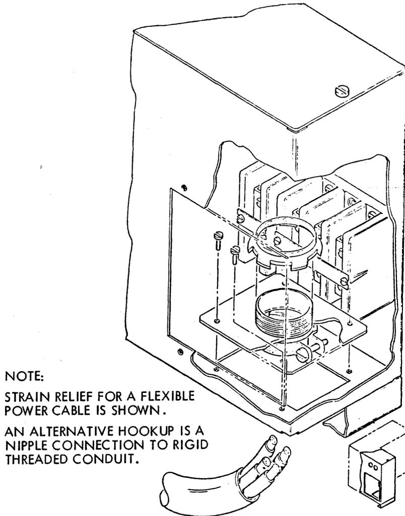
Figure IV-6. B 1712/B 1714 AC Power Terminals
