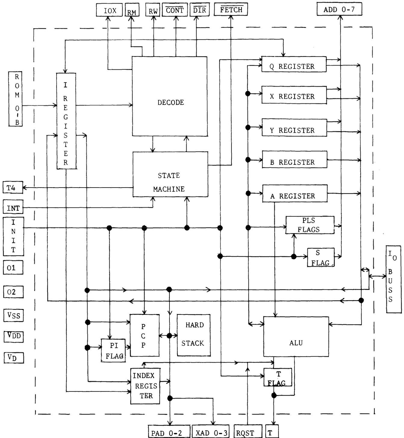
FIG. IIC-118 BLOCK DIAGRAM TPU LSIC
