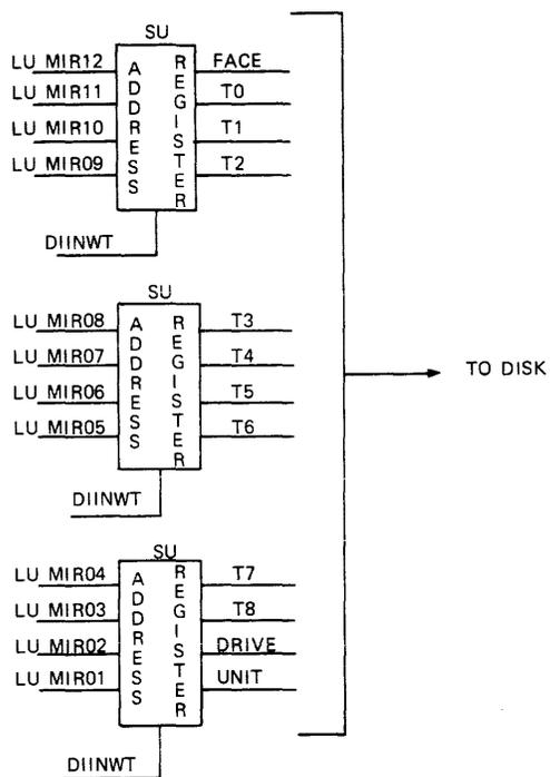
Fig. II-8 ADDRESS REGISTER
