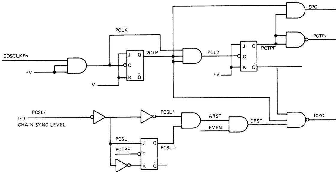
Fig. II-4 CLOCK CIRCUIT
