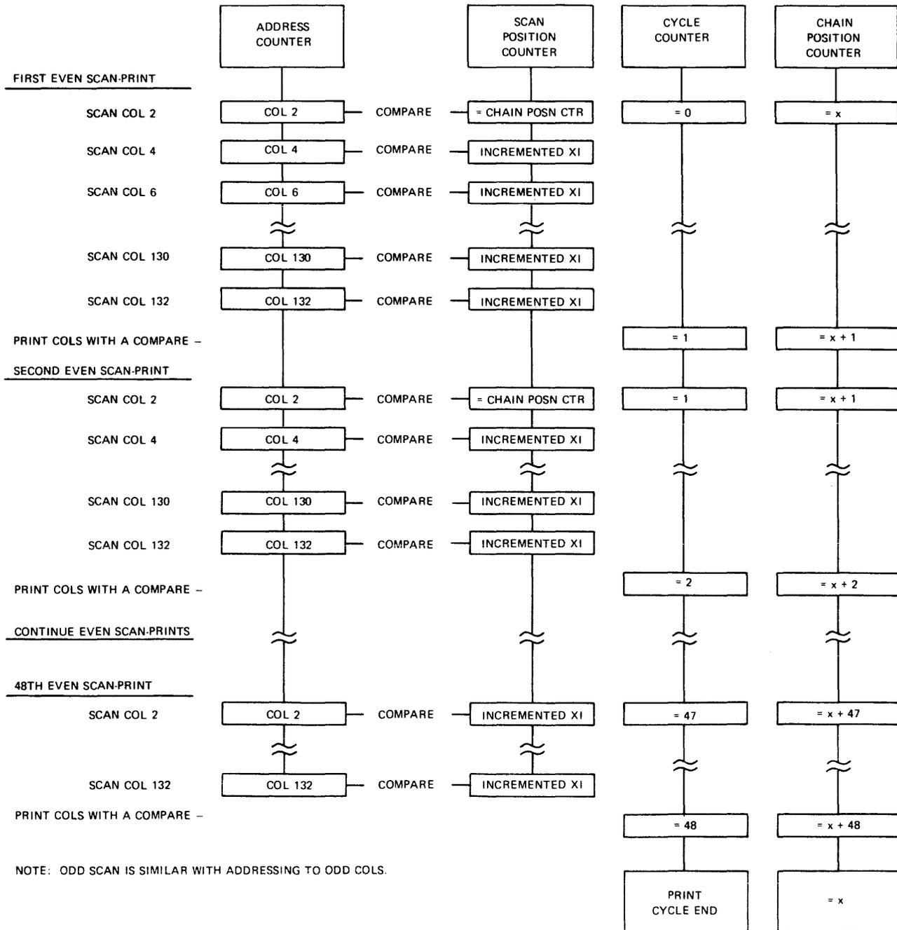
Fig. II-2 400 - LPM EVEN SCAN OPERATION
