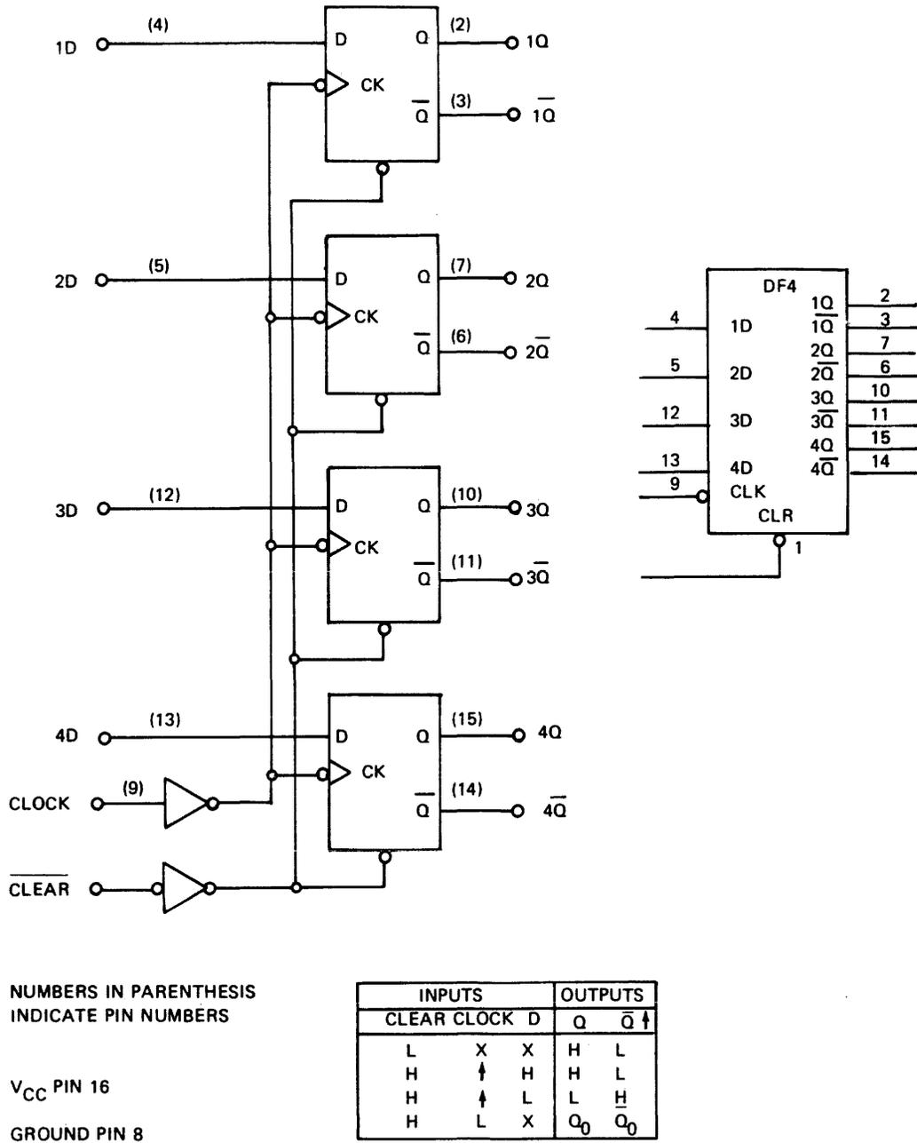
Fig. III-3 QUAD D-TYPE FLIP-FLOP (1449 1278)
