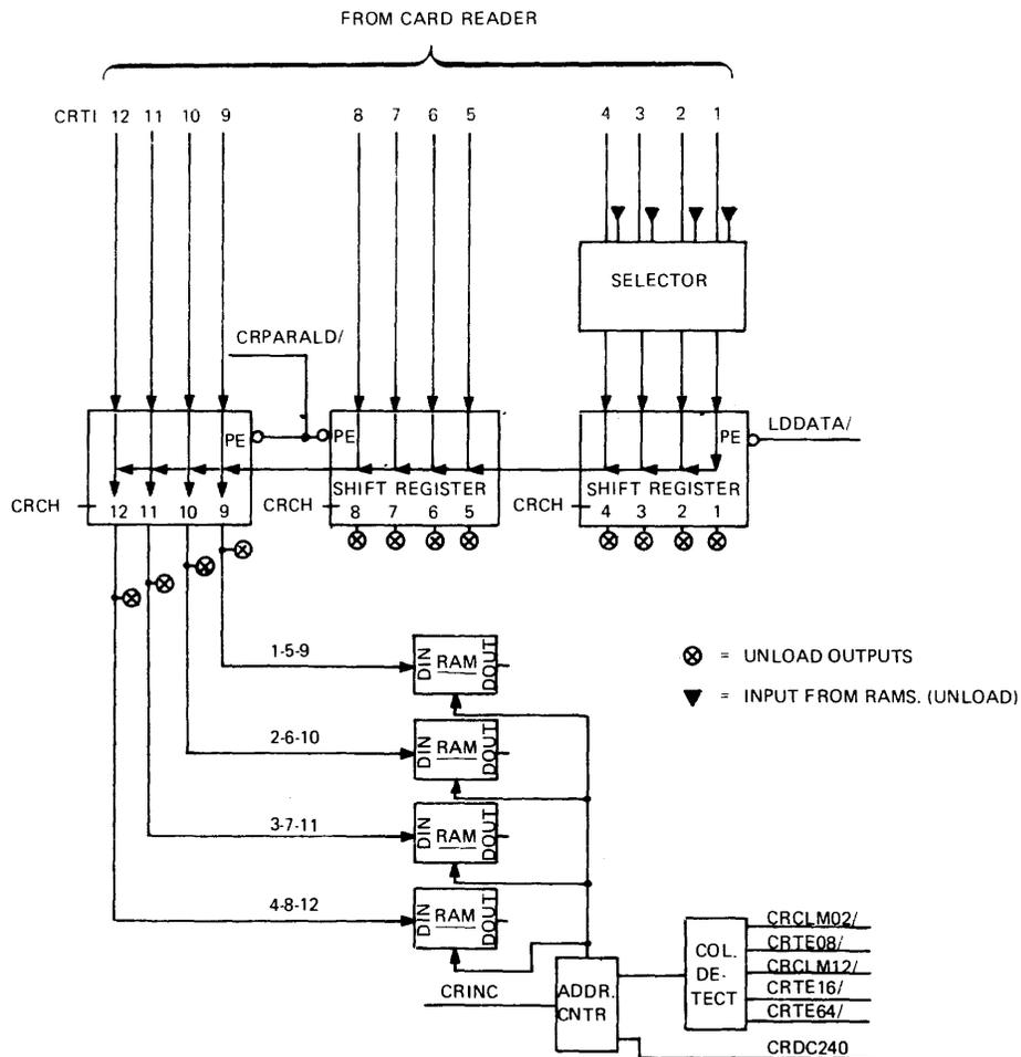
Fig. II-1 BUFFER LOAD OPERATION
