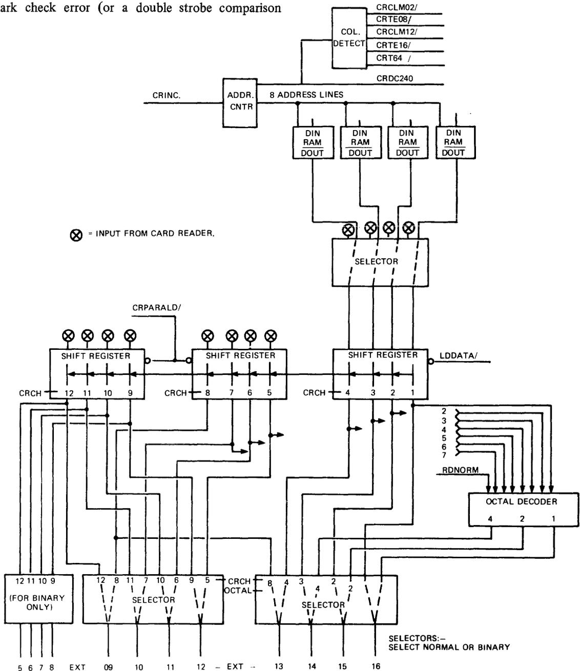
Fig. II-4 BUFFER UNLOAD OPERATION
