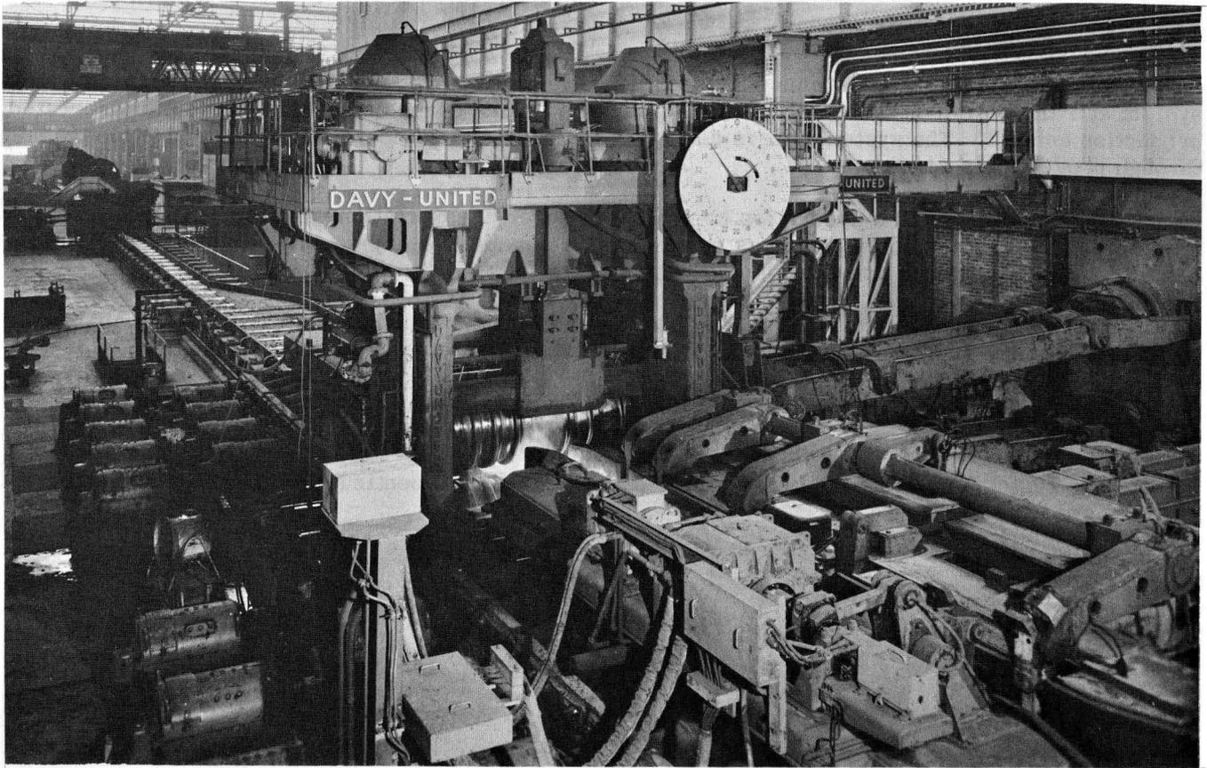
**THE BLOOM MILL ROLLS RED-HOT FIVE TON INGOTS INTO BLOOMS OR SLABS**
