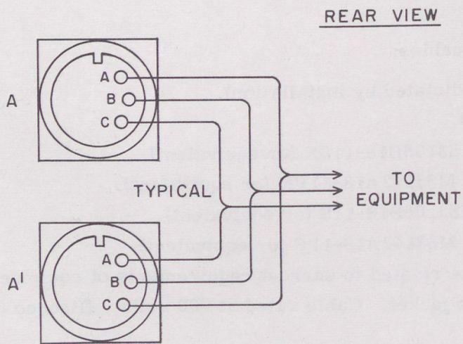
ALL CONTACTS SHALL BE JUMPED TOGETHER. CONTACT b SHALL BE GROUNDED. PARALLEL CONNECTOR A' ALLOWS CONNECTION TO OTHER EQUIPMENT.
