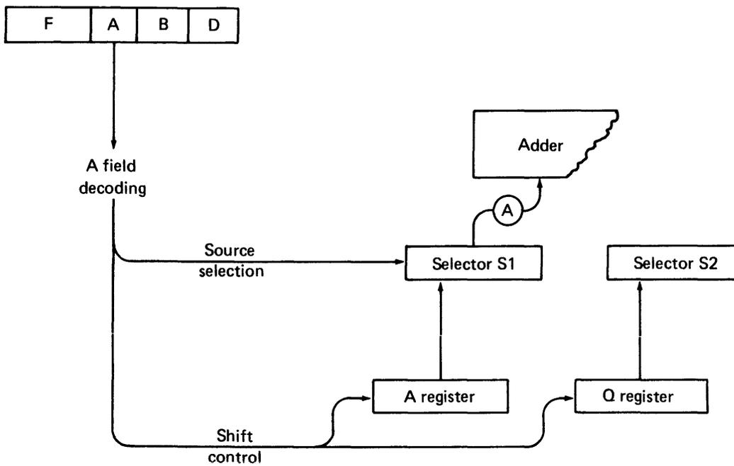
Figure 2-9. A-Field Decoding
