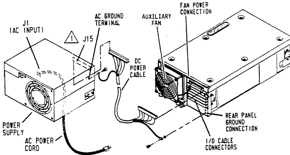
1 DO NOT TOUCH PINS ON CONNECTOR J15. POWER SUPPLY CIRCUITRY IS SENSITIVE TO ELECTROSTATIC DISCHARGE.
