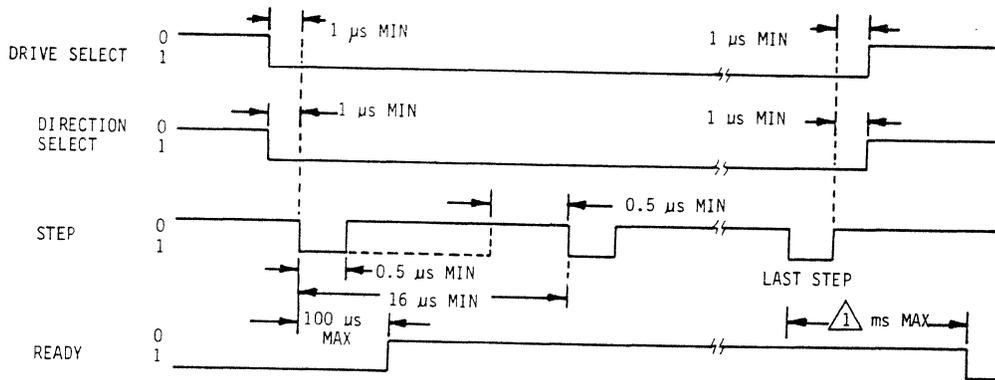
$\triangle$  -- 10 ms FOR A SINGLE TRACK SEEK (I.E., 1 STEP PULSE).
