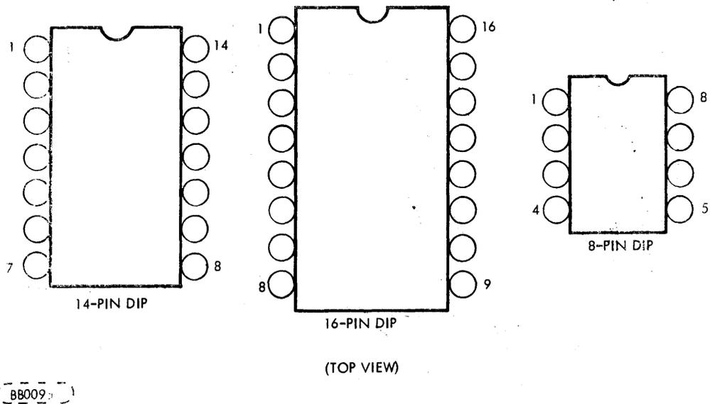
FIGURE 5-4. IC PACKAGE LAYOUT
