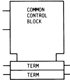
INPUTS TO THE COMMON CONTROL BLOCK AFFECT EVERY TERM IN THE ARRAY. INPUTS TO EACH TERM AFFECT ONLY THAT TERM.
