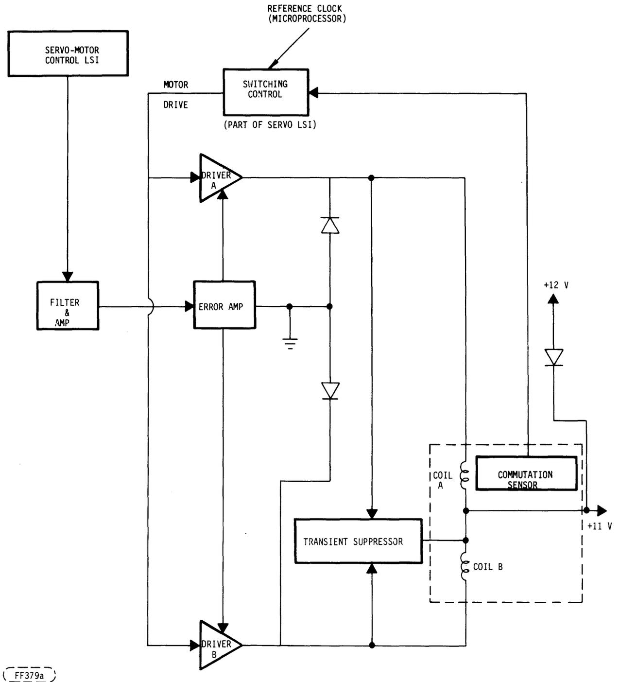
FIGURE 4-34. MOTORIZED SPINDLE DRIVE
