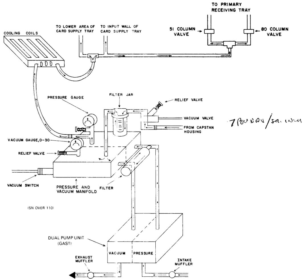
VACUUM & PRESSURE COMPONENTS OF THE PNEUMATIC SYSTEM
