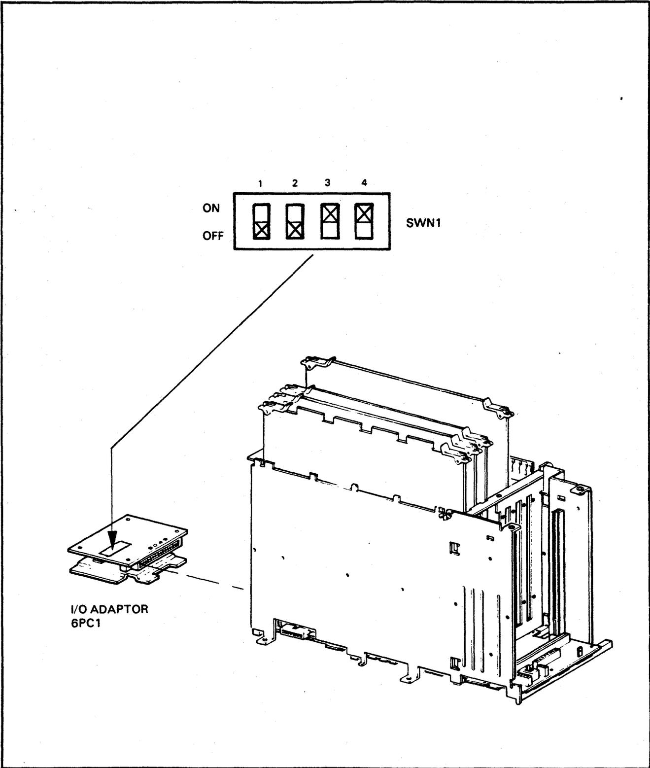
FIGURE 2-3. I/O ADAPTOR (6PC1) FACTORY SWITCH SETTINGS.
