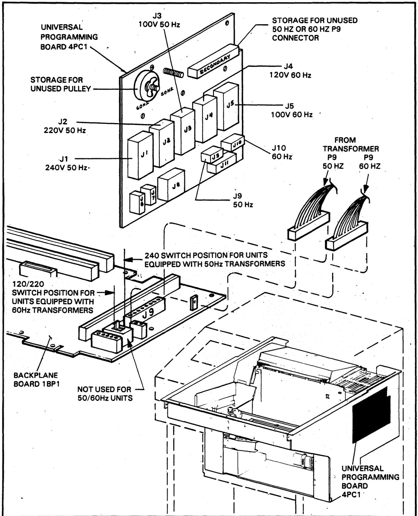
FIGURE 1-5. INPUT POWER FREQUENCY MODIFICATIONS 50 Hz/60 Hz UNITS ONLY
