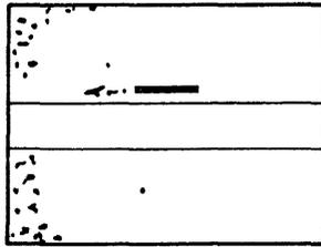
A. SLIGHT OXIDE BUILDUP. HEAD SHOULD BE CLEANED AND USED
