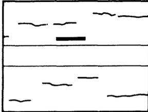
C. SLIGHT SCRATCHES. NO OXIDE BUILDUP. HEAD IS USABLE
