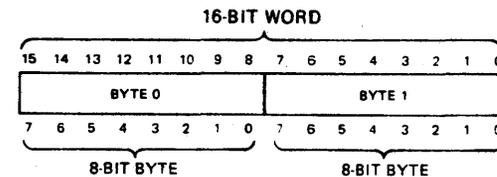
Figure 1-2. Byte Storage, Two Bytes Per Word
