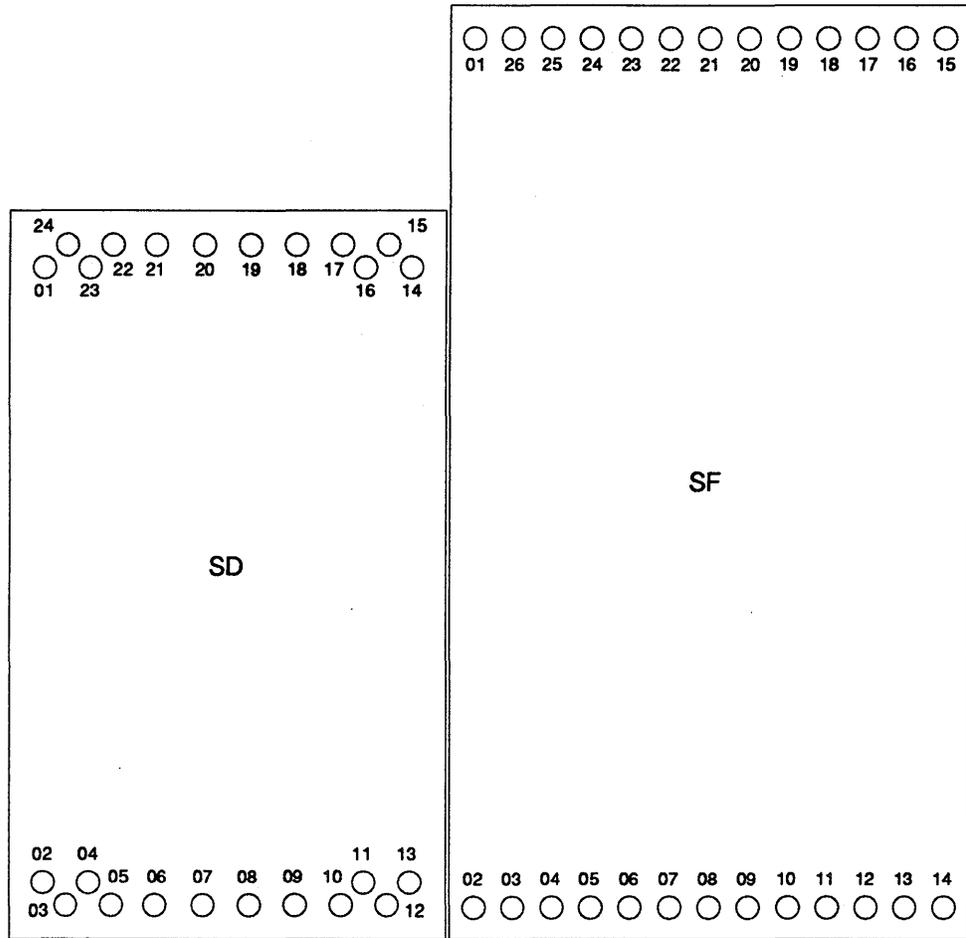
**FIGURE 55. SM Die Pinouts.**
