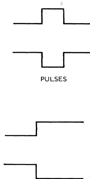
LEVELS, TRANSITION SHOWS DIRECTION OF INITIAL MOVEMENT. LEVEL REMAINS UNTIL OTHER ACTION IS TAKEN.
