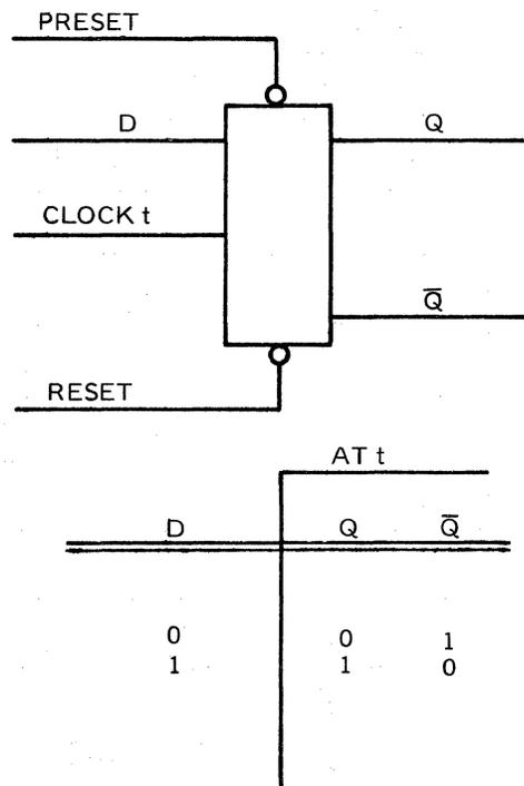
**Figure 1-3. D Flip-Flop**
