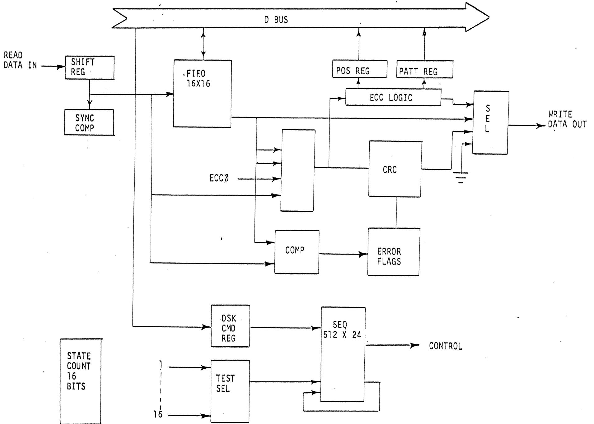
DISK DATA SEQUENCER BLOCK DIAGRAM
